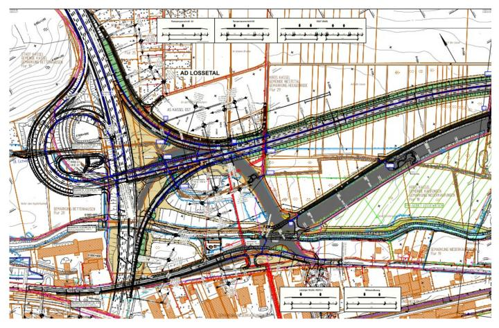
Bild: Alles in dunkelgrau wird zurückgebaut: bestehende B7 und Auffahrt Kassel-Ost. Alles in bunt wird neu gebaut: A 44 mit Anschluss Kassel-Ost
